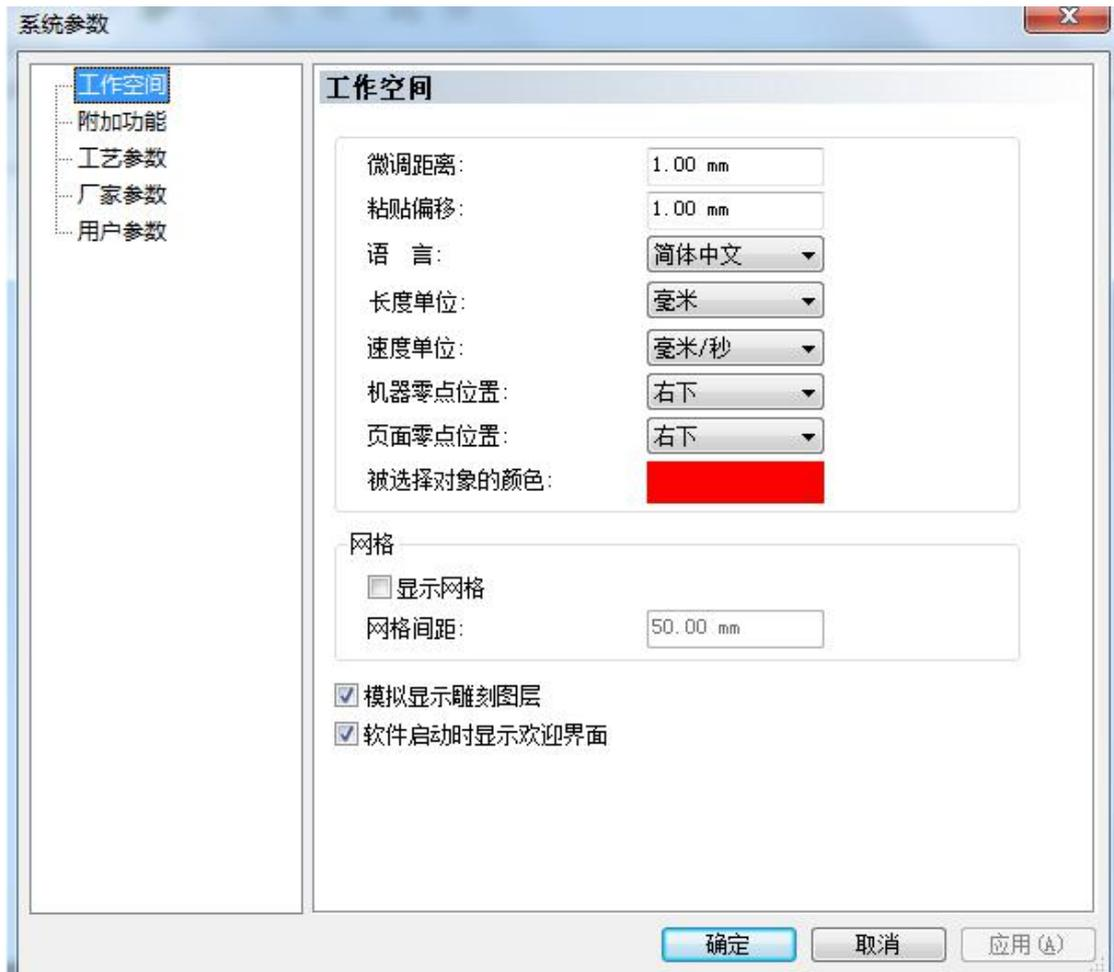
把机器零点位置和页面零点位置改成右下角。后点确定完成
