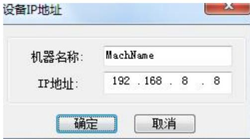
, 可直接修改 IP 地址，注意此处显示的 IP 地址必须和机器控制面上显示的 IP 地址一致（按控制面上的设置键，向下找到网络参数，按确定键可查看 IP 地址） 最后修改电脑本地连接的 IP 地址。由于不同的电脑使用的 IP 地址有差异。如有疑问可直接联系 18663732527 咨询！
